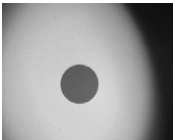
Figura 37. Conector para ONT de la casa 5 limpio
