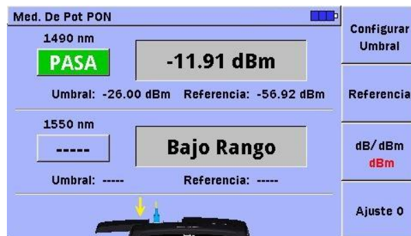
Figura 40. Potencia de Rx (Downstream) del ONT en casa 6 a 1490 [nm] con fibra correctamente sujeta
