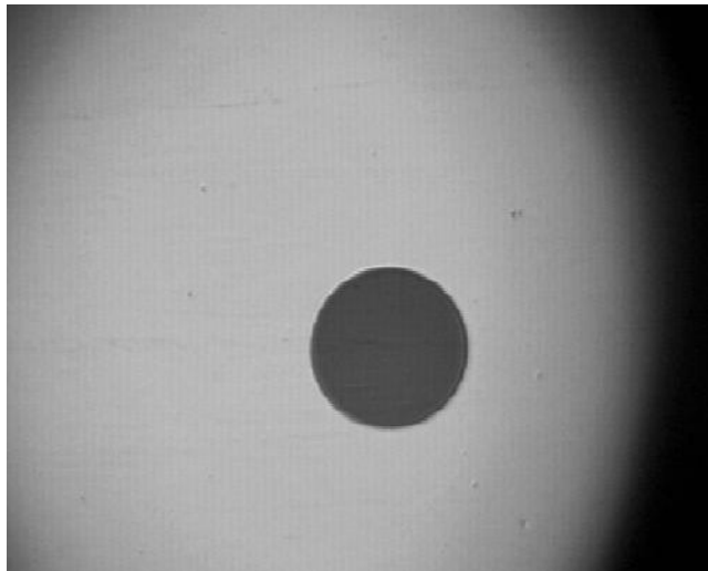
Figura 33. Nuevo conector del ONT de la casa 2 limpio
