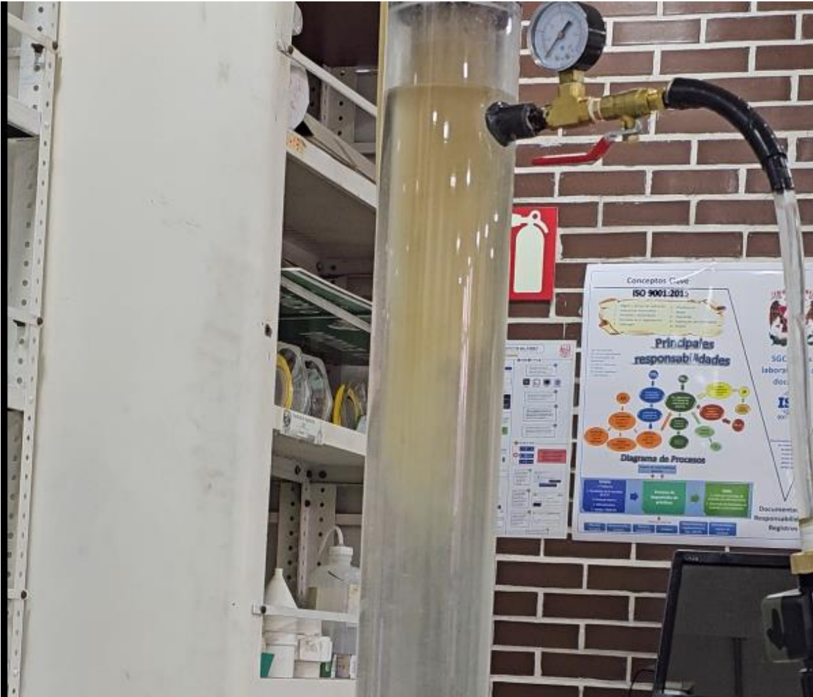
Ilustración 26 Desplazamiento de fluido de trabajo con fluido de terminación.
