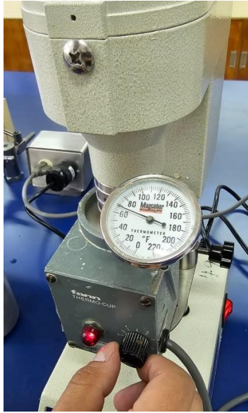
Ilustración 16 Viscosímetro rotacional con termocopa.
