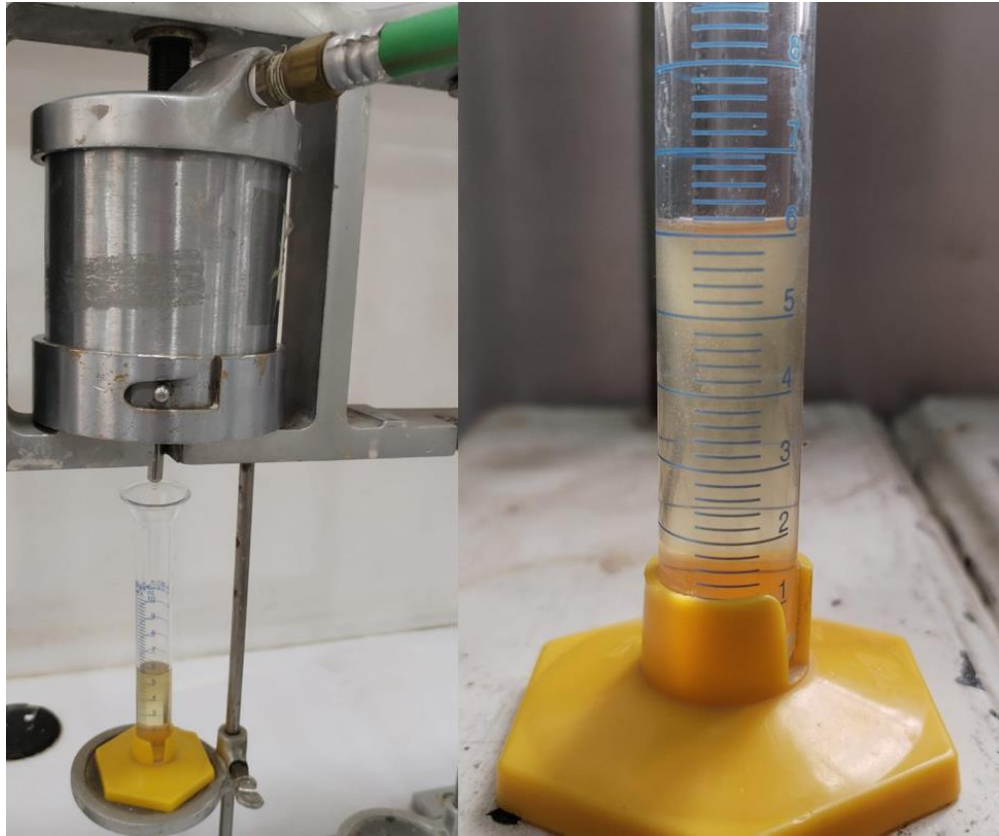
Ilustración 19 Filtro prensa y la fase continua desplazada.
