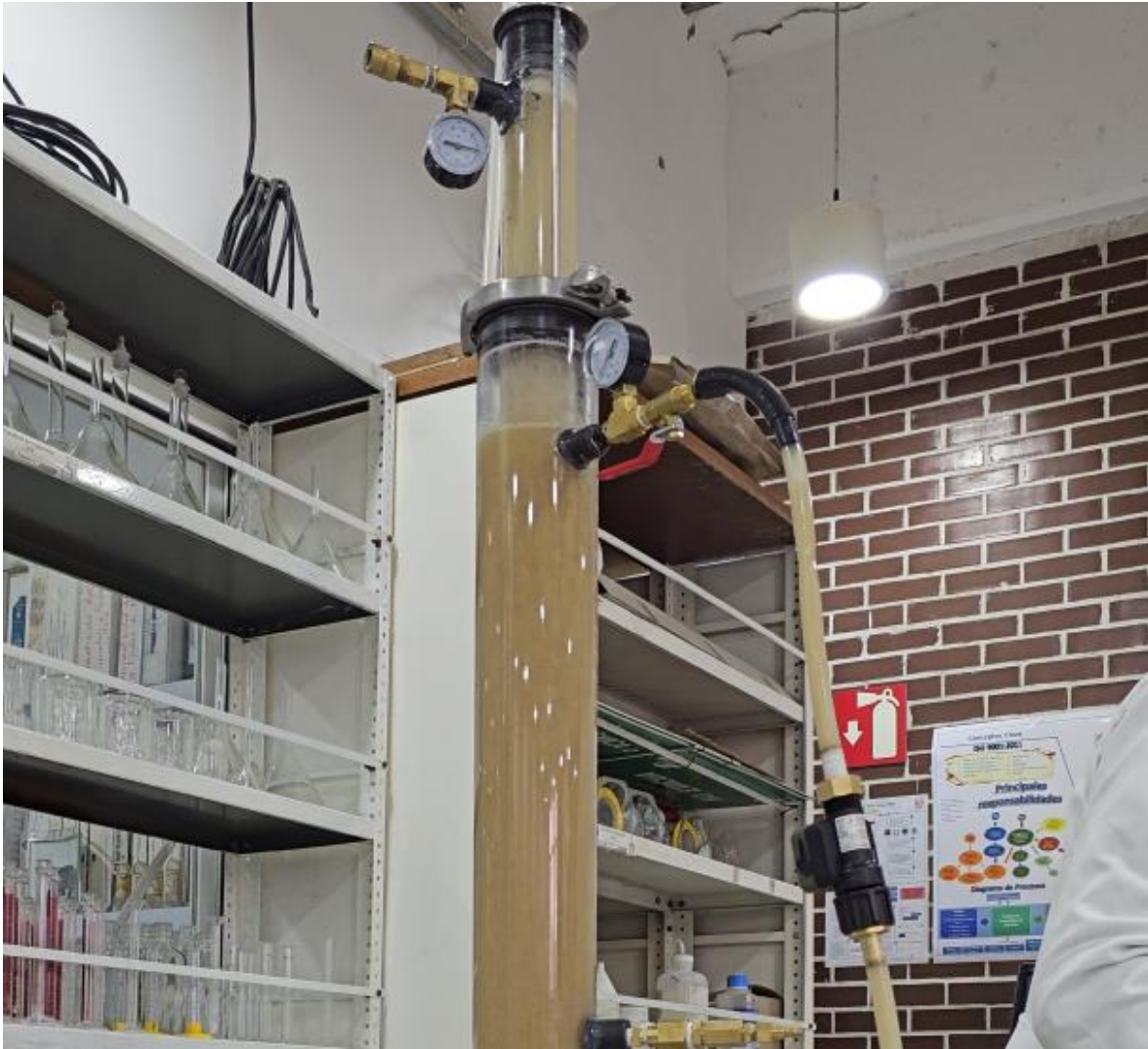
Ilustración 27 Simulador lleno de fluido de terminación.
