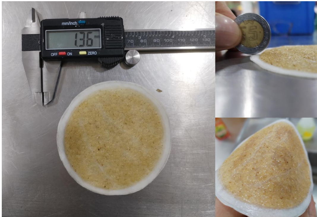
Ilustración 20 Película impermeable generada por el fluido después de agregar los aditivos.
