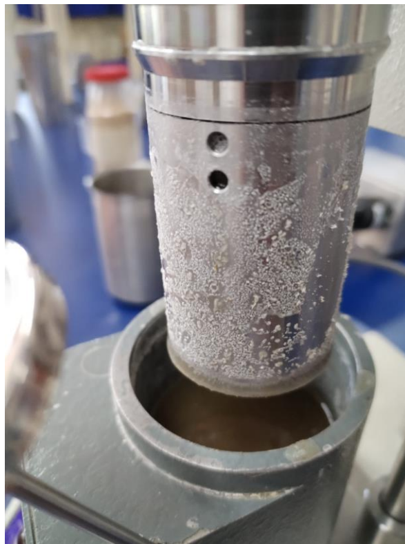
Ilustración 15 Cristalización generada en la prueba a 175° F en el Viscosímetro Rotacional
