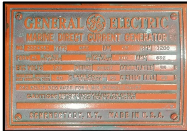
Figura 2.10 Placa de datos característica máquina de corriente directa módulo Marino
