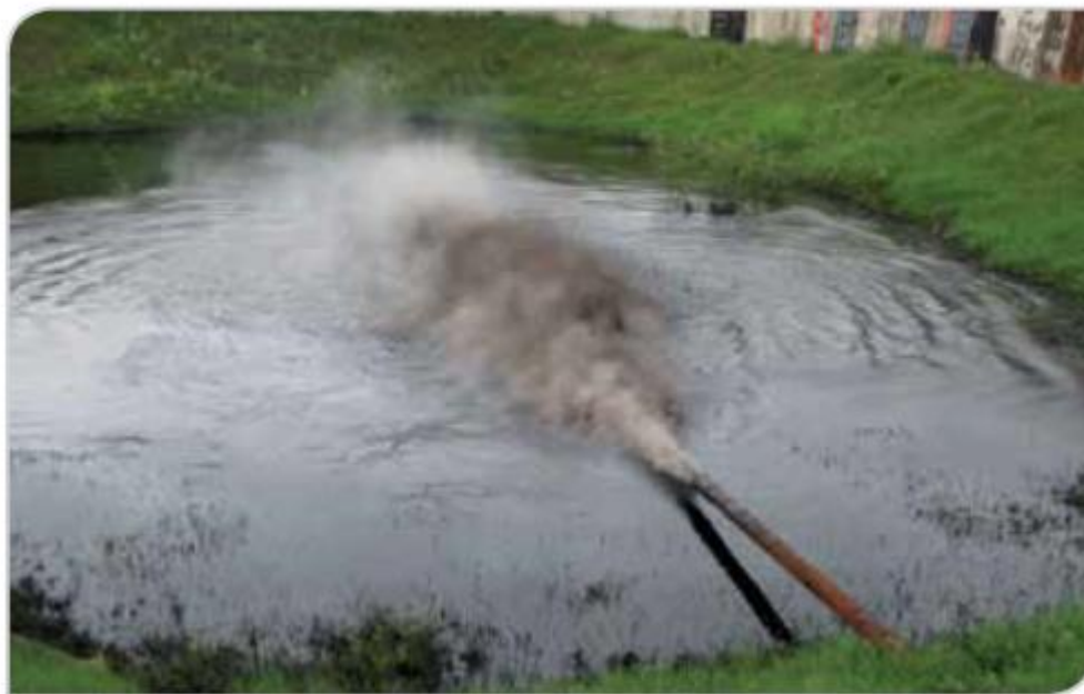
Figura 3.9 Apertura a presa de quema del pozo Samaria 916, después de estimulado. Obtenido de "Logros y retos de la primera prueba piloto de inyección de vapor en México" Arteaga, 2013
