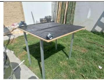
Figura 3.3 Colector solar en su base.
