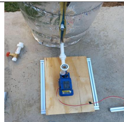
Figura 3.11. Elementos principales: Bomba de circulación y válvula de corte
