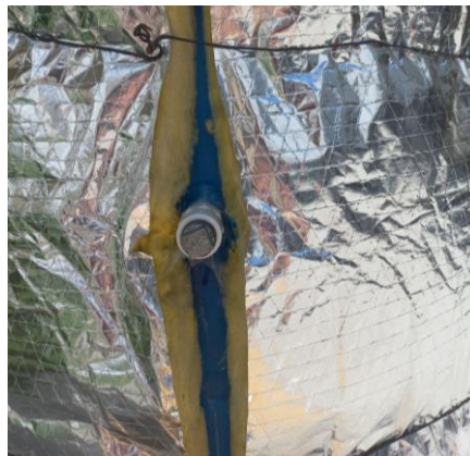
Figura 3.7 Adaptador del tanque para el tercer termo-pozo
