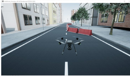
Figura 2.5: Simulación de drones de alta fidelidad mediante el bloque Simulation 3D Scene Configuration. En este caso se requiere Unreal Engine para implementar los escenarios.
