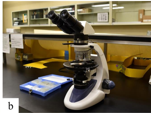
Fig. 23. Equipo para el análisis de muestras. (a) Analizador Beckman Coulter modelo LS 230, de difracción láser (Fotografía de ICMYL, 2019); (b) Microscopio polarizante Velab VE-148 P y láminas delgadas (Fotografía de Carlos-Delgado, 2021).
