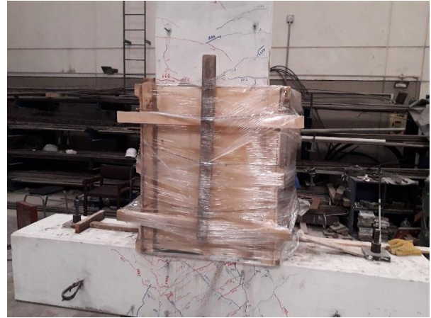
Figura 23. Fin del colado y emplayado de la zona rehabilitada
