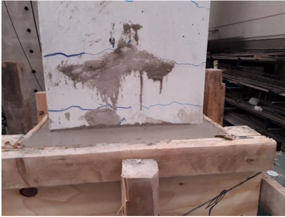
Figura 23. Fin del colado y emplayado de la zona rehabilitada
