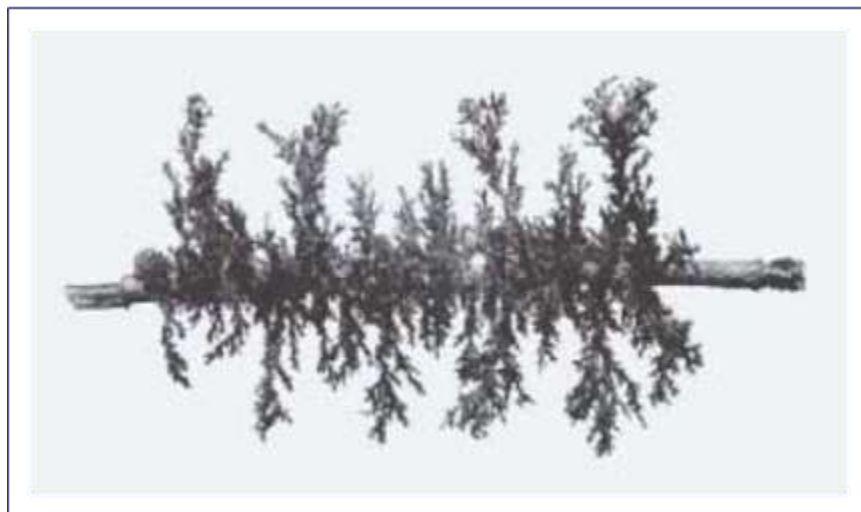
Figura 4.12 Modelo tomado después de una acidificación de la matriz con carbonato de calcio. Se observa la red de agujeros de gusano que se forman (Wayne, 2004).
