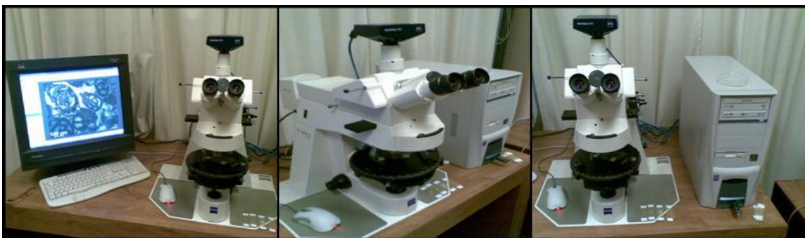
Figura 1.14.- Fotografía del microscopio petrográfico con cámara Carl Zeiss AxioCam, utilizado para fotografiar las láminas delgadas en este estudio. (Instituto Mexicano del Petróleo Sede, México D.F.).
