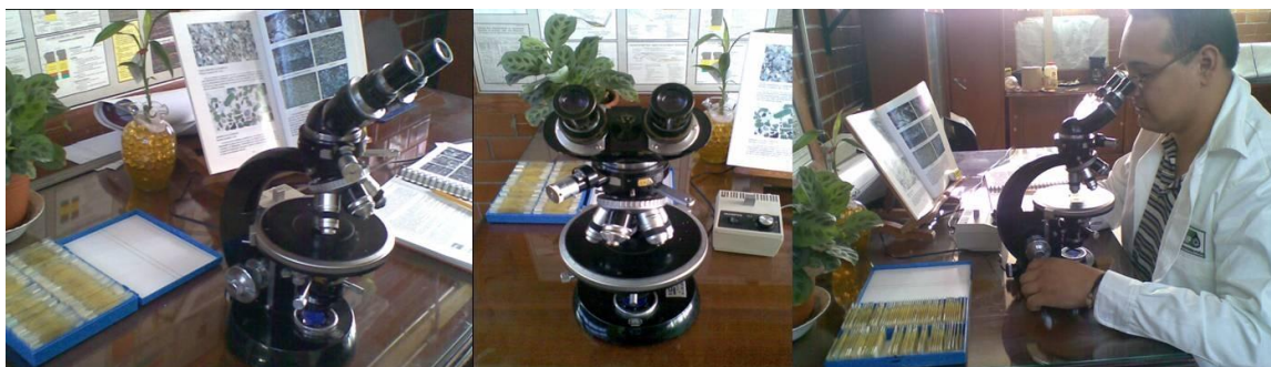
Figura 1.13.- Fotografía del microscopio petrográfico marca Carl Zeiss utilizado en este estudio (Instituto Mexicano del Petróleo Sede, México D.F.).
