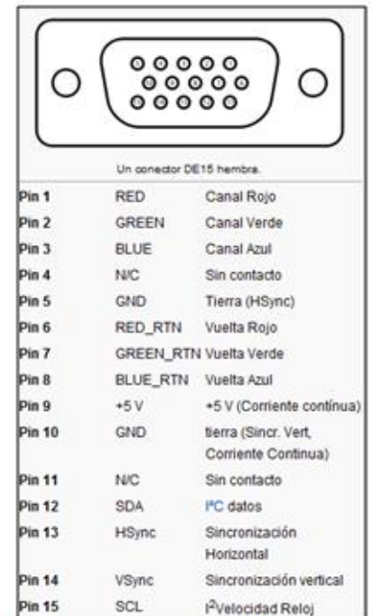
Fig. 89. Distribucion de Pines VGA
