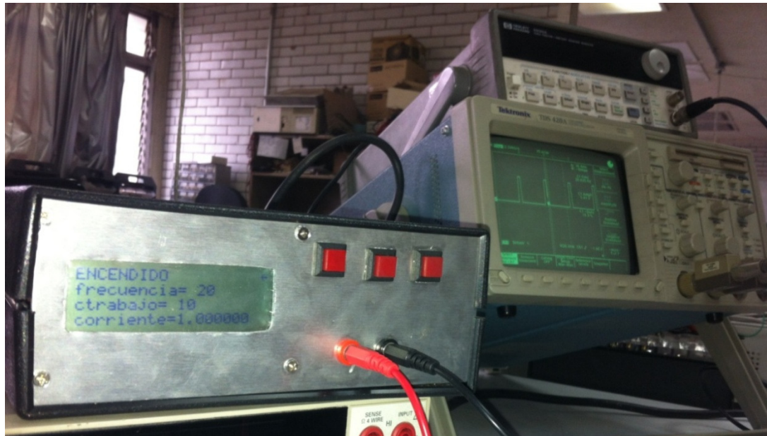
Figura IV.1 Prueba del Bioestimulador con el osciloscopio
