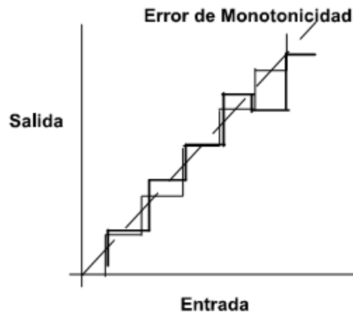
Figura III.28 Error de monotonicidad
