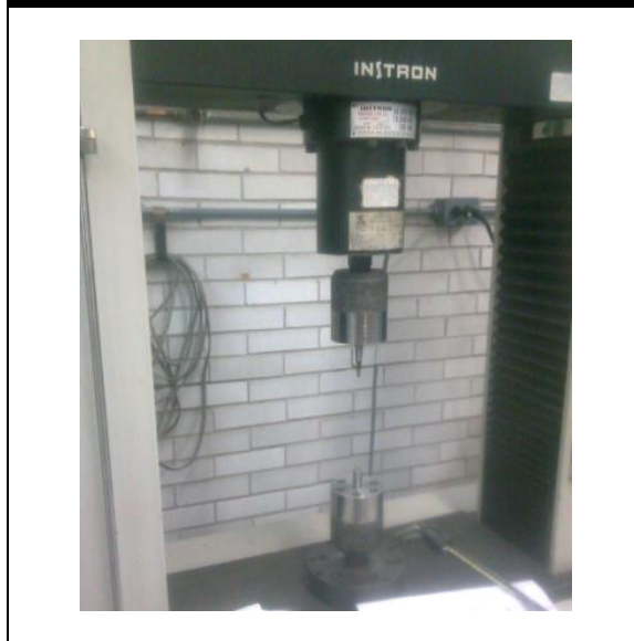
Figura 3.5. Ensamble del herramental en maquina universal.
