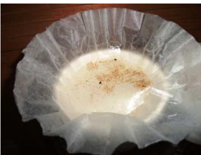
Figura e.25 La muestra 1 es la que tiene el uso adecuado del aceite de cocina por lo que se observa una cantidad moderada de partículas retenidas en el filtro.
