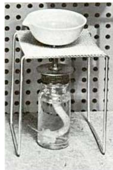
Figura a.6 El método utilizado para la separación del alcanfor, es la separación de sólidos por sublimación, consistente en que un sólido se calienta y se convierte en vapor sin pasar por el estado líquido, y el vapor se vuelve a solidificar en contacto con una superficie fría
