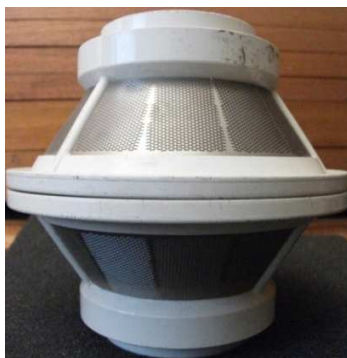
Figura e.6 Se observa cómo se utilizan 2 filtros tipo canasta para liberar el aceite de partículas de gran tamaño. Ésta canasta bloquea partículas de hasta .254mm.
