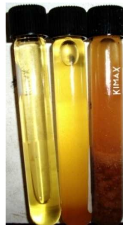
Figura a.38 Muestra 2 dividida en 3 contenedores. Las muestras fueron obtenidas de la sección superior, media e inferior de la muestra decantada por gravedad
