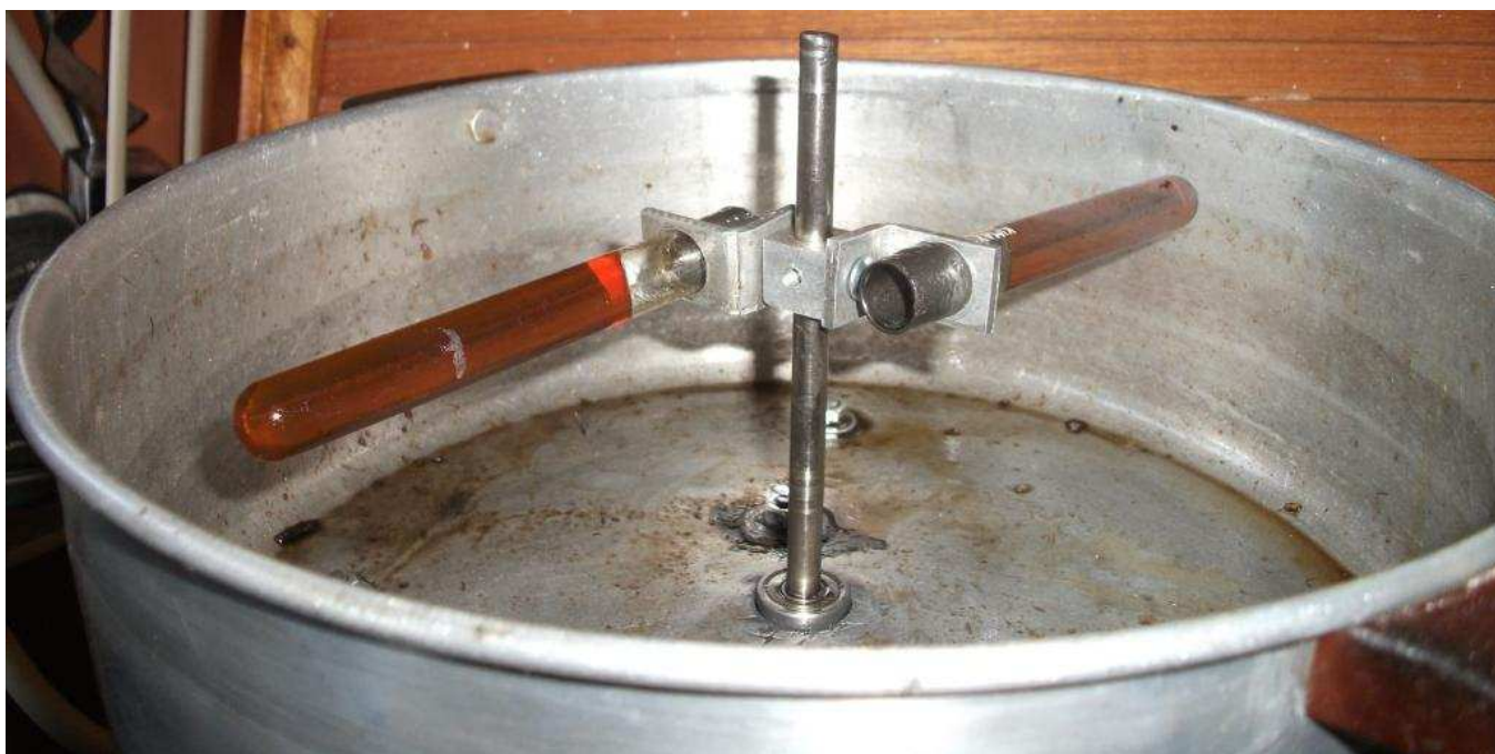
Figura am3 Vista de los vasos de ensayo sometidos a la fuerza centrífuga, como se observa los vasos se encuentran en una posición horizontal.
