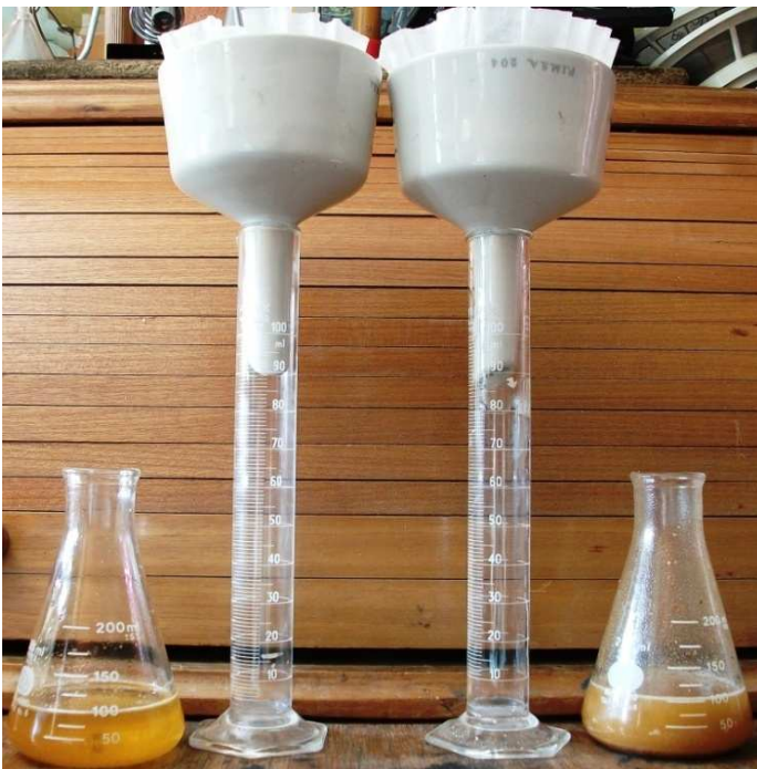
Figura e.26 Muestras colocadas en embudos para contener el papel filtro y a su vez montados en probetas graduadas de 100ml para conocer el porcentaje de filtrado.
