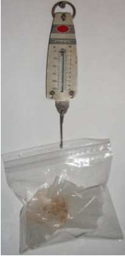
Figura e.21 Toma de muestra de referencia y su masa es de 5gr que va a ser descontada en cada muestra.
