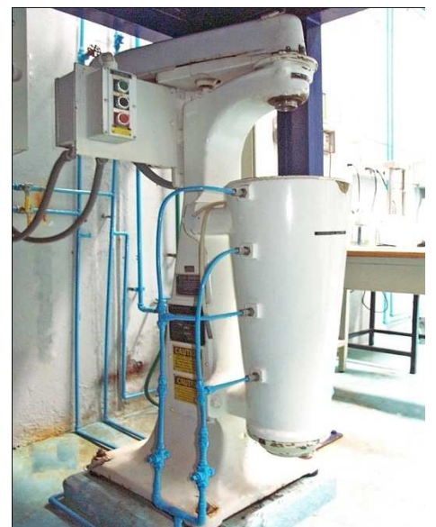
Figura a.19 Centrífuga tubular modelo AS16 Súper Sharples
