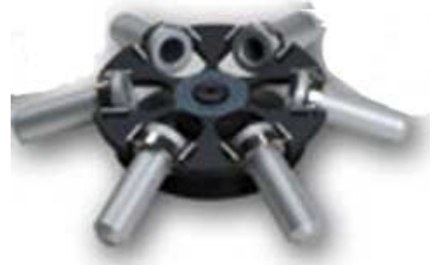
Figura d.16 Cabeza para centrifugadora labtec Modelo ZS206A. Esta cabeza para centrífuga permite que los vasos de ensayo puedan estar en estado vertical cuando la centrífuga se encuentre detenida lo que permite que el vaso se hubique en posición horizontal cuando la maquina se encuentre operando. .
