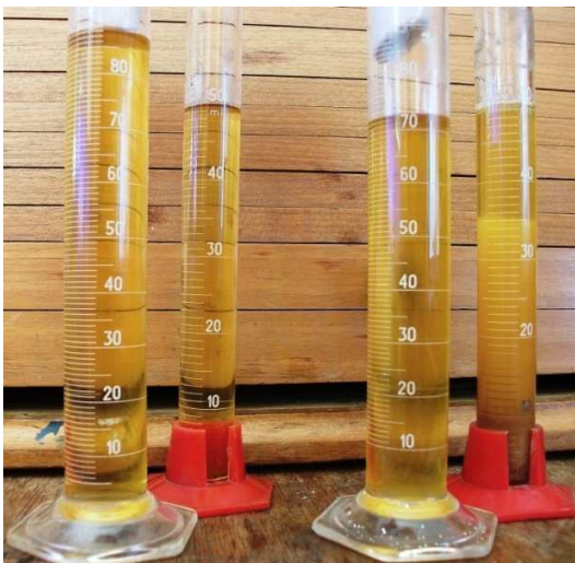
Figura e.28 Después de 14 horas se realizó el filtrado de la muestra 2 (figura e.28). Teniendo una pérdida por sedimentos del 26 % de partículas solidas.
