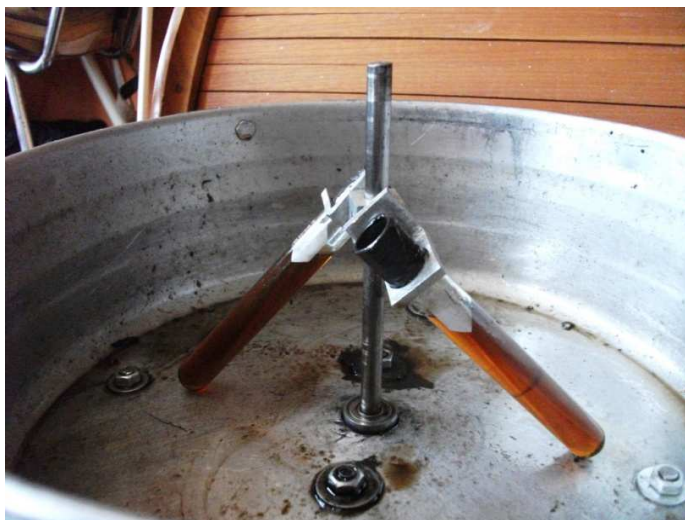
Figura an.1 imagen del prototipo fabricado y vista de los contenedores llenos antes de proceder al centrifugado.
