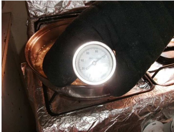
Figura e.14 Toma de temperatura con un termómetro bimetálico marca Metron con un rango de exactitud de \pm 1^{\circ}
