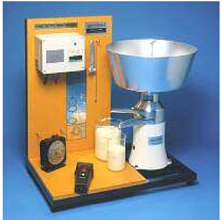
Figura a.20 Centrífuga de discos separadora de leche
