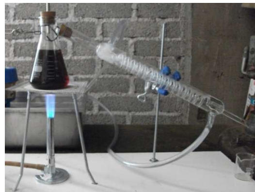
Figura a.4 Destilación de agua por medio de un tubo refrigerante de vidrio enfriado por agua.
