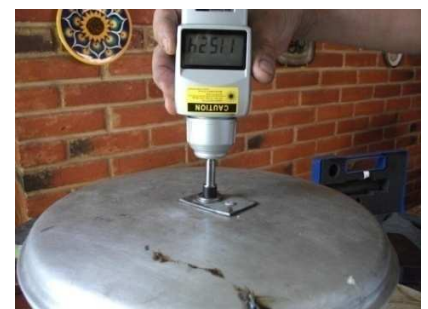
Figura a.35 Revoluciones alcanzadas para filtrar la mezcla en un de filtro tipo canasto.
