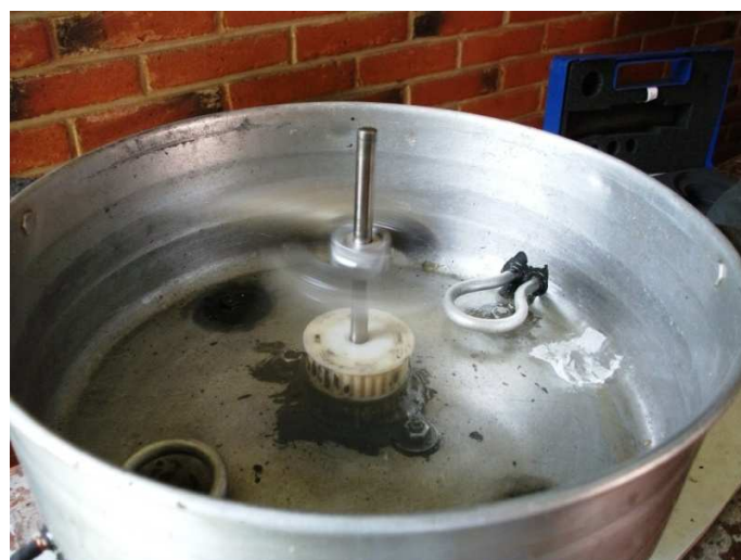
Figura am2 Puesta en marcha del prototipo centrífugo y se observa su alta velocidad que es de aproximadamente 1000 rpm.
