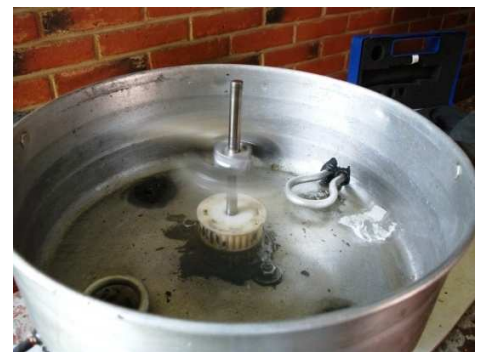
Figura r.4 Es importante tener en cuenta la temperatura a la que se va a realizar el centrifugado debido a que si se trabaja en regiones polares la densidad del aceite podría aumentar por lo que se requeriría de un precalentamiento de la mezcla.
