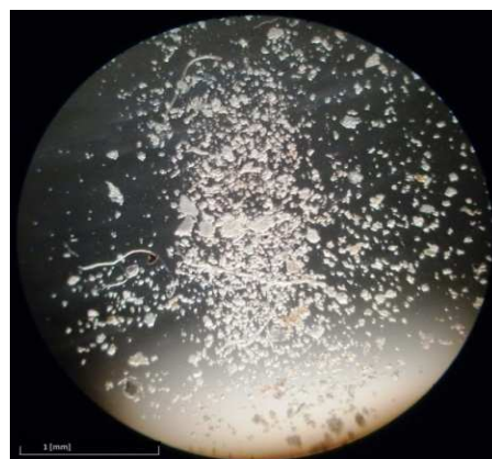
Figura e.9. Muestra de aceite tomada a 80X en un microscopio óptico, como se puede observar existen partículas suspendidas en una fase intermedia de aceite.
