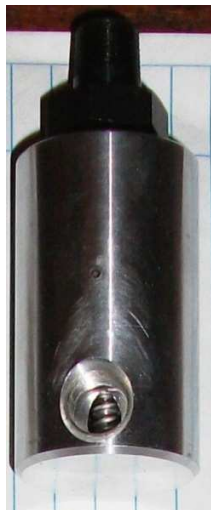
Figura d.3 junta rotativa transmite el fluido en un dispositivo rotatorio.
