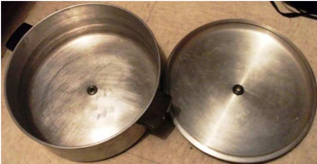
Figura e.3 Olla de aluminio utilizada como contenedor con sus respectivos rodamientos en el centro.
