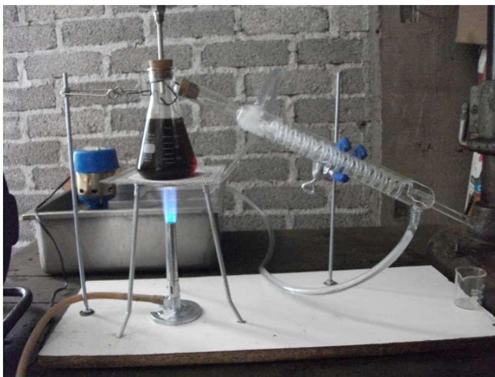
Figura a.40 Matraz Kitasato de 250 ml y bureta de 15 ml. Para medir la expansión térmica del aceite.
