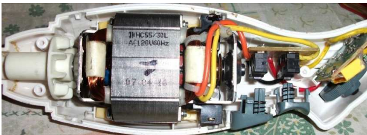
Figura e.1 Motor de batidora de mano de 120 volts 60 hertz y 200 watts modelo hc55 30.
