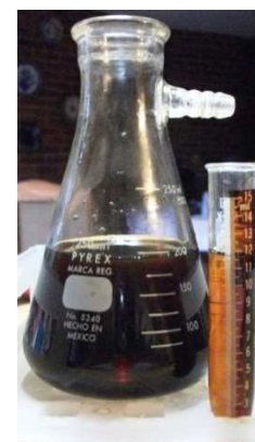
Figura a.40 Matraz Kitasato de 250 ml y bureta de 15 ml. Para medir la expansión térmica del aceite.
