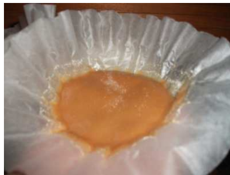
Figura e.26 Como se puede observar en la muestra 2, se tiene una mayor concentración de partículas debido a que dicha muestra se utilizó para freír papas y pollo entre otros por lo que además de partículas retenidas se aglomeran glóbulos grasos de alta densidad en el filtro .
