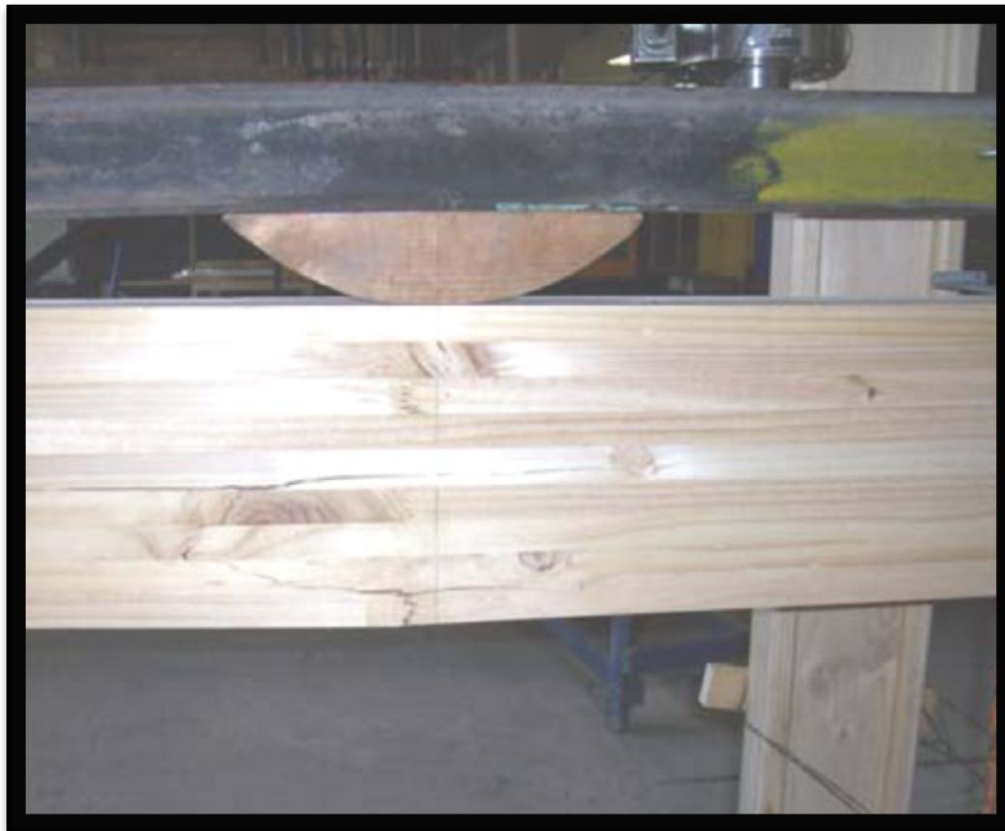
Fig. 3.3 En esta figura falla es similar a la figura anterior (falla en la unión artificial).
