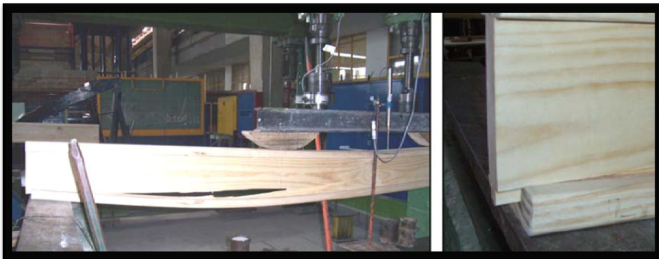
Fig. 3.6 En una de las vigas de madera en I, el fenómeno de falla se inicia por deslizamiento en la parte que adhiere al patín con el alma, sin embargo la carga con la que ocurrió fue extraordinaria, respecto del resultado de la otra viga I, similar a esta.
