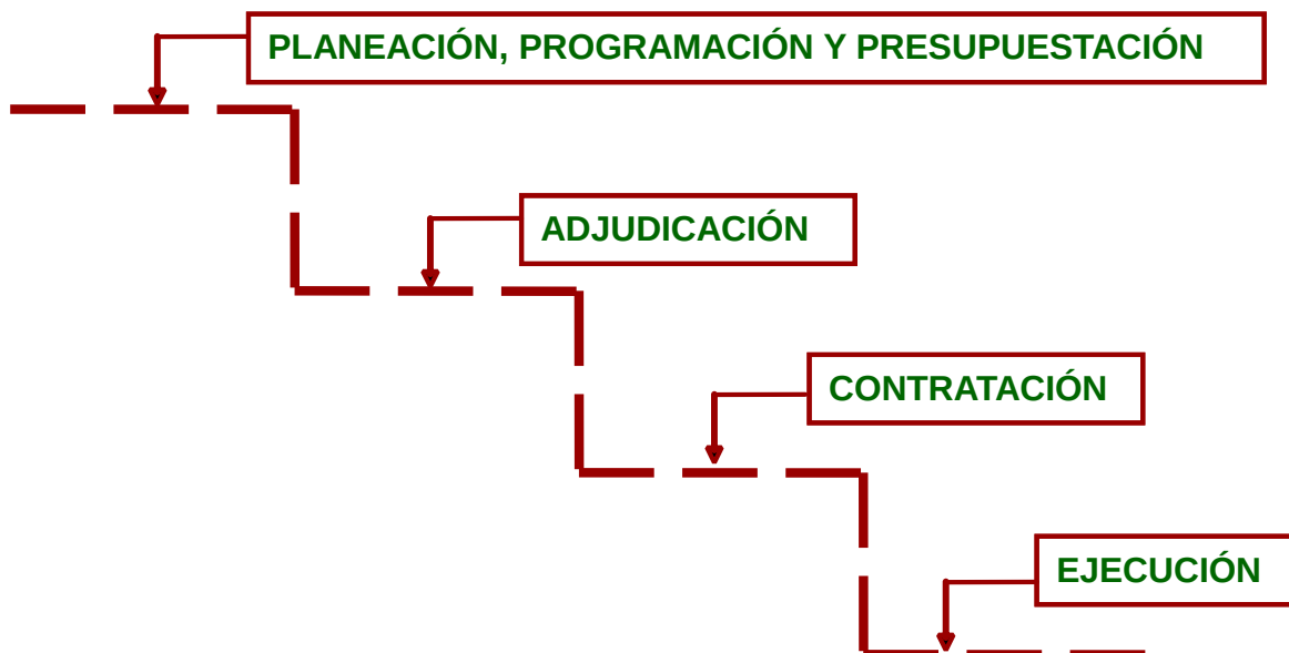
Figura 11. Procesos en la realización de la obra pública.
