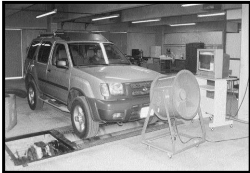
Fig. II.16. Prueba sobre Dinamómetros de chasis a) Con camioneta convencional b) vehículo ligero.
