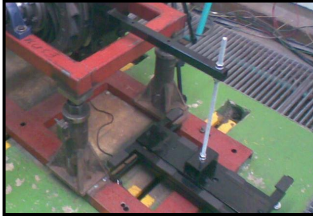
Fig. VII.3. Balanza Industrial empotrada para medir par
