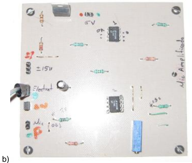
Figura 3.61: Circuito impreso, micrófono electret, a) Diseño en PCB WIZARD, b) Circuito armado.
