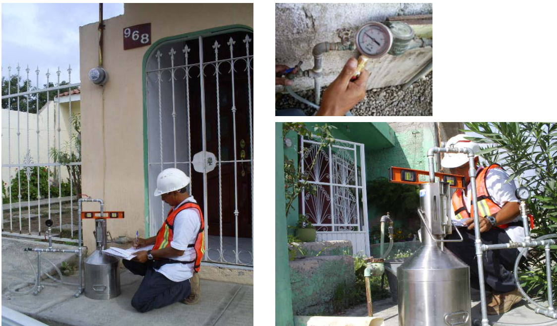
Figura 3.9. Evaluación de Micromedidores en campo
