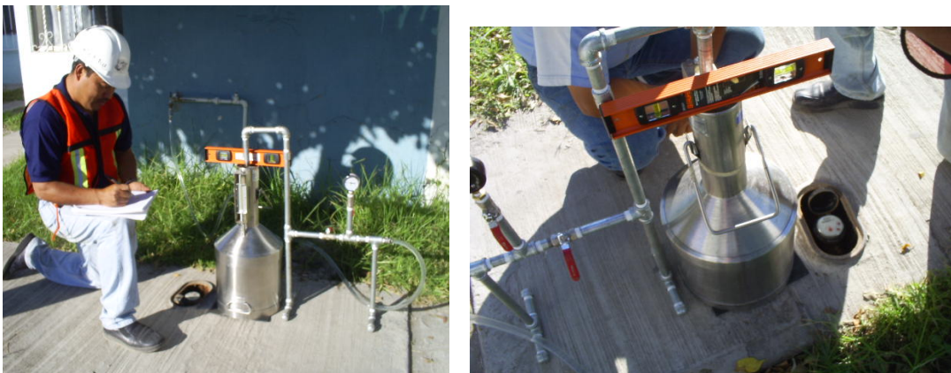
Figura 3.12. Evaluación de Micromedidores en campo
