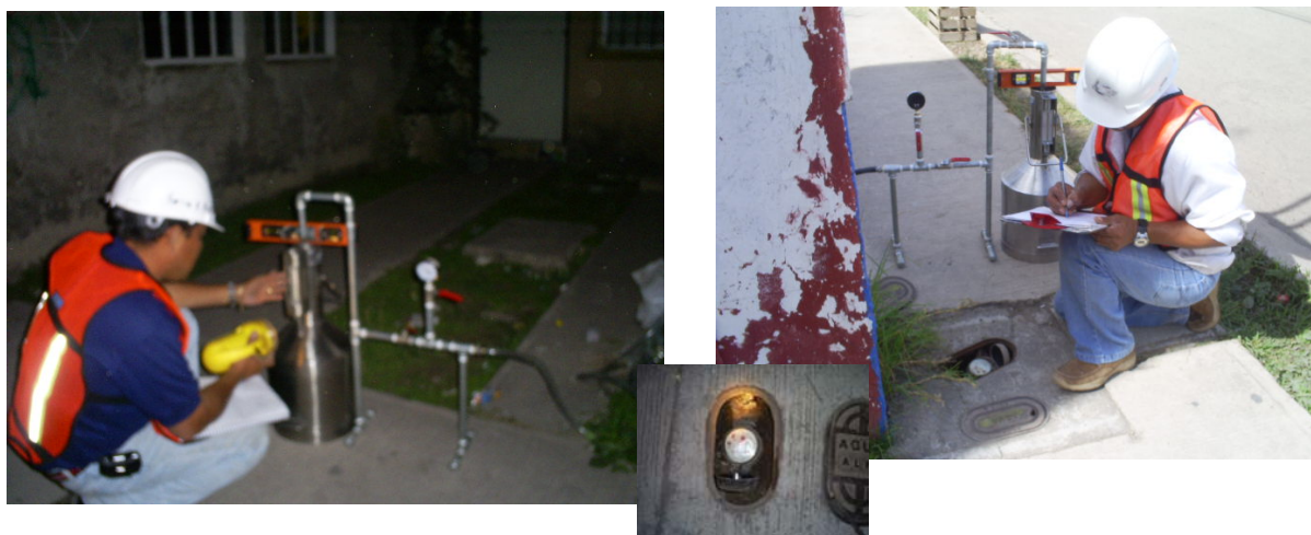
Figura 3.10. Evaluación de Micromedidores en campo
