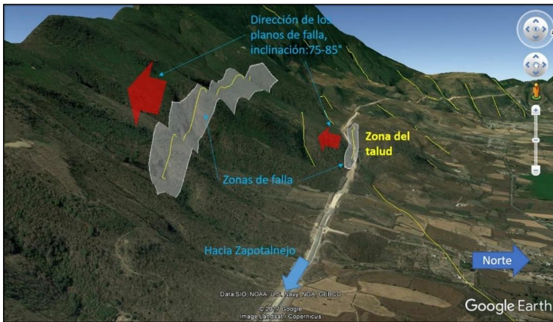
Figura 4.5 Zonas de falla posibles. La zonificación y la altura en Google Earth, la escala vertical está exagerada 3 veces.
