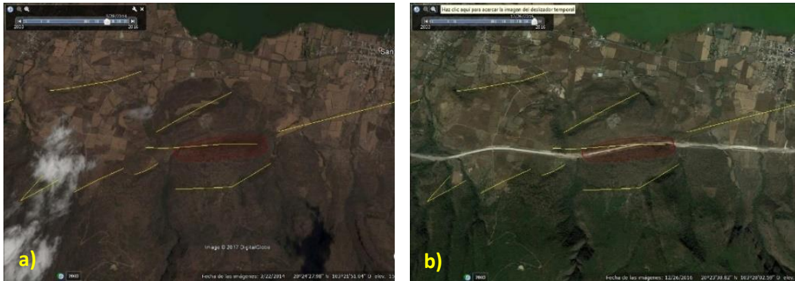
Figura 4.4 a) lineamientos interpretados con imagen de marzo de 2014 previo a la construcción de la autopista, b) lineamientos interpretados con imagen de diciembre de 2016.
