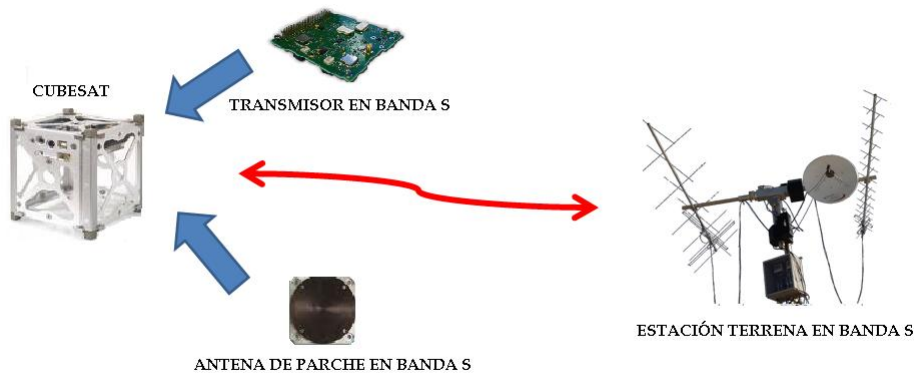
Figura 7.2: Sistema de comunicaciones en banda S.
