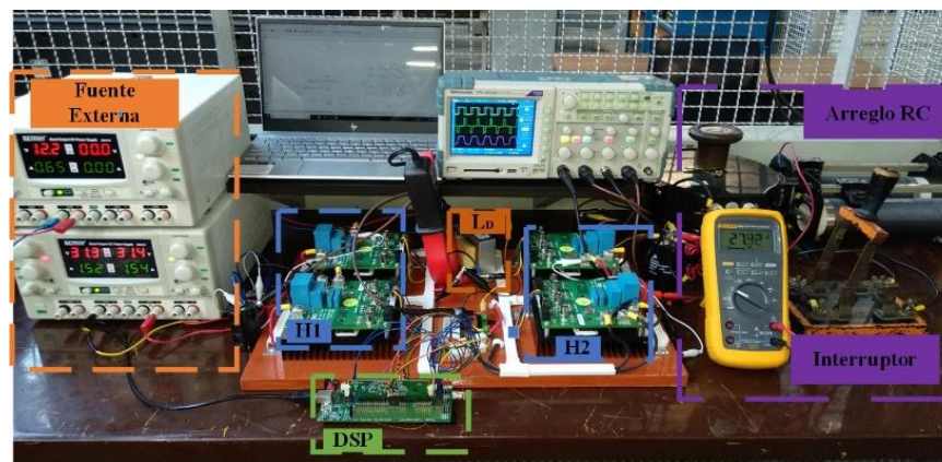
Figura 4.16.- Aspecto real del prototipo construido operando con un control de voltaje en una carga.
