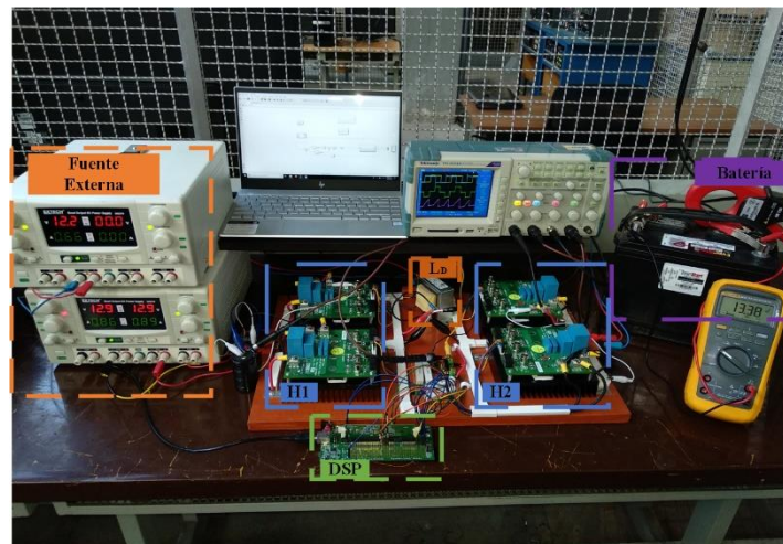
Figura 4.21.- Aspecto completo del prototipo cargando una batería de auto de 12 V.
