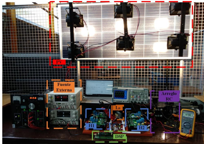
Figura 4.9.- Aspecto general del prototipo construido operando en lazo abierto
