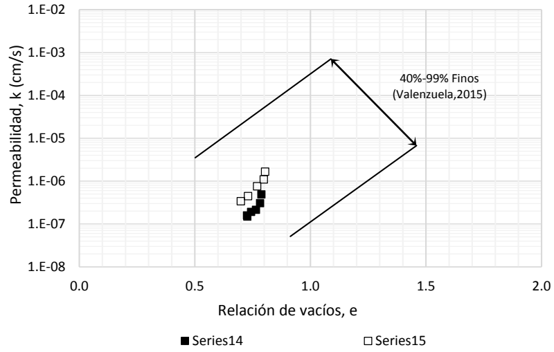
Figura 164. Permeabilidad en función del contenido de finos para ensaye M7.
