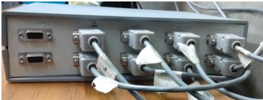
Figura 52. Acondicionador de señal.
