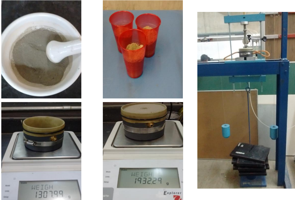
Figura 90. Formación de probetas por compactación estático.
