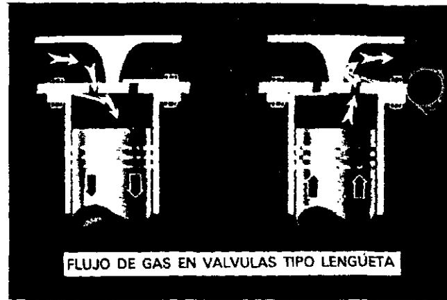
FIGURA R6-14 Flujo de gas por válvulas de lengüeta. (Cortesía de Carrier Air-Conditioning Company)
