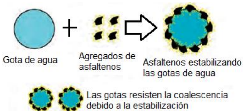
Figura 1.12 Mecanismo de estabilización de emulsiones (Kokal, 2006).
