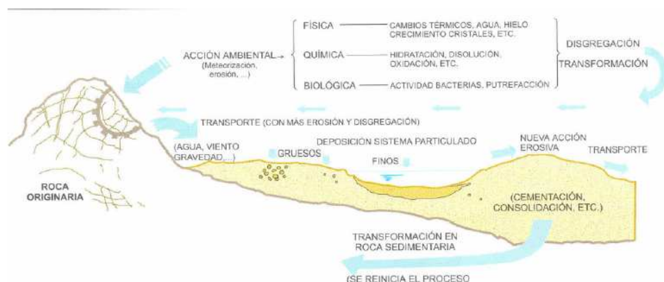
Figura 4.2.- Esquema del proceso de formación de los suelos.
