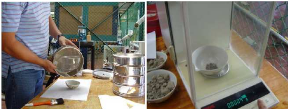
Figura 4.27.- Proceso de cribado y pesado de la muestra de suelo, en la prueba de granulometría.
