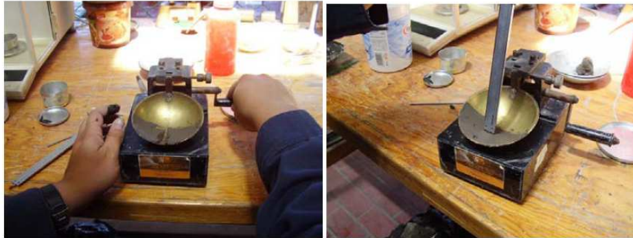
Figura 4.28.-Determinación del límite líquido, mediante la Copa de Casagrande.
