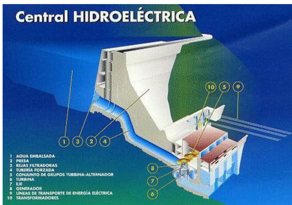
Figura I.4 Esquema de una minihidroeléctrica de “pie de presa”
