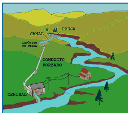
Figura I.3 Esquema de una minihidroeléctrica de “agua fluyente”
