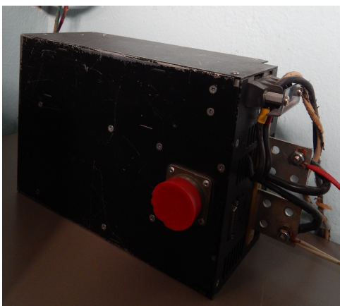
Figura 3.6. Fuente de alimentación del armario de PA
