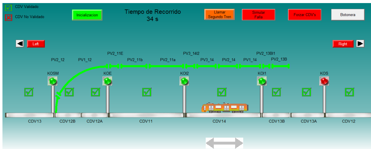
Figura 4.31. Tren sobre CDV forzado
