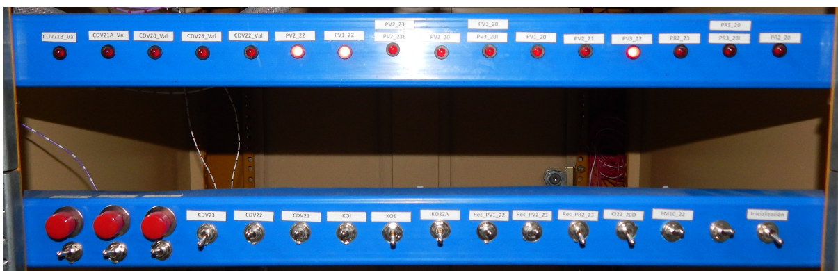
Figura 4.2. Barra de LED e interruptores
