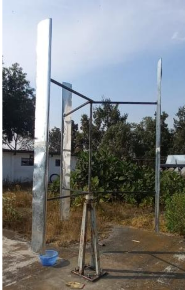
Figura 41. Ensamble final del rotor eólico de eje vertical.
