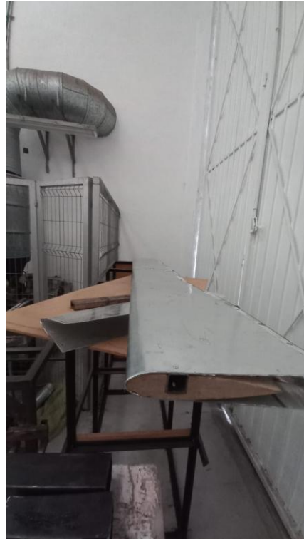
Figura 38. Perfiles NACA 0018 sobre el larguero (izquierda) y ensamble del álabe completo (derecha).
