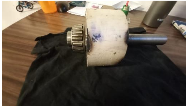
Figura 40. Ensamble del eje principal y rodamiento del rotor.
