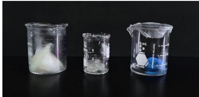
Figura 15. Soluciones precursoras. De izquierda a derecha: colágena, quitosano de alto peso molecular y policaprolactona.
