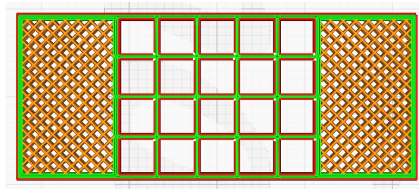
Figura 19. Diseño de la probeta generada con el archivo “.stl”, el cual descompone la pieza 3D en una serie de capas 2D. Además, se observa el patrón geométrico para el llenado de capas en el plano xy.
