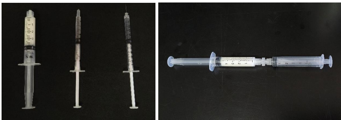
Figura 16. Izquierda: Volúmenes de soluciones precursoras a utilizar. Derecha: Sistema de agitación de las tintas mediante jeringas conectadas.
