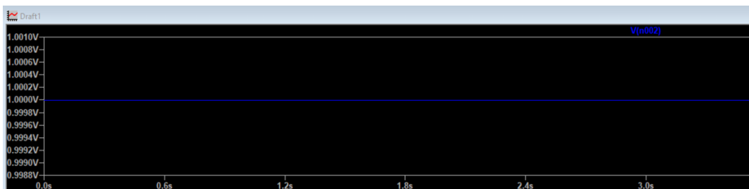
Figura 2.22. Voltaje de Salida de 1 [V].
