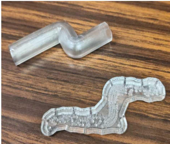
Figura 11. Prueba de impresión de tubería en orientación horizontal.
