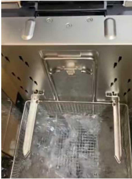
Figura 9. Proceso de lavado de piezas impresas en resina
