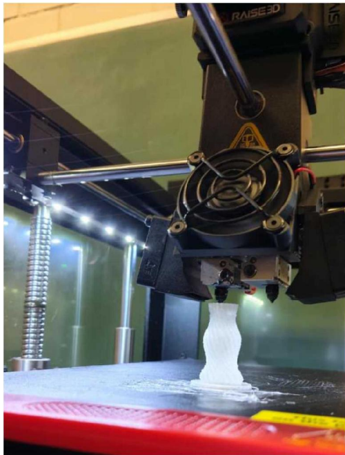
Figura 21. Impresión de un jarrón en filamento para verificar el correcto funcionamiento del extrusor.
