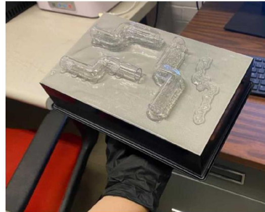
Figura 10. Impresión de múltiples tuberías con diferentes configuraciones de soportes.
