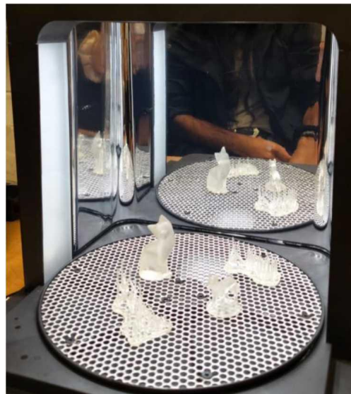
Figura 18. Impresión de piezas de prueba utilizadas para que los alumnos comprendan el proceso de impresión en resina y filamento.
