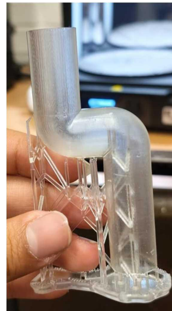
Figura 13. Prueba de impresión de tubería en orientación completamente vertical.
