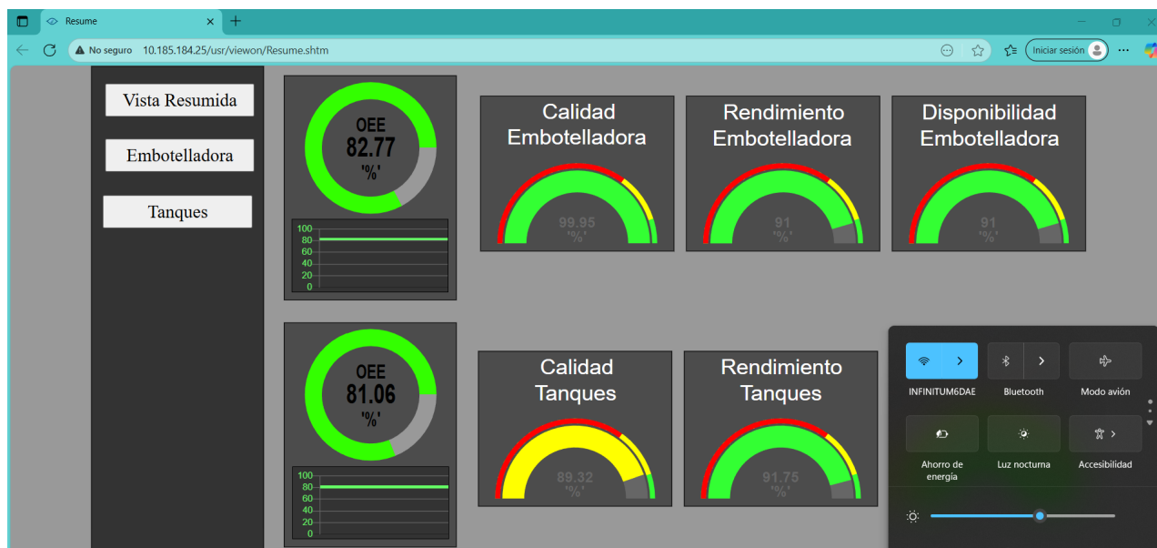
Figura 4.13 Interfaz de supervisión principal mediante una conexión remota.
