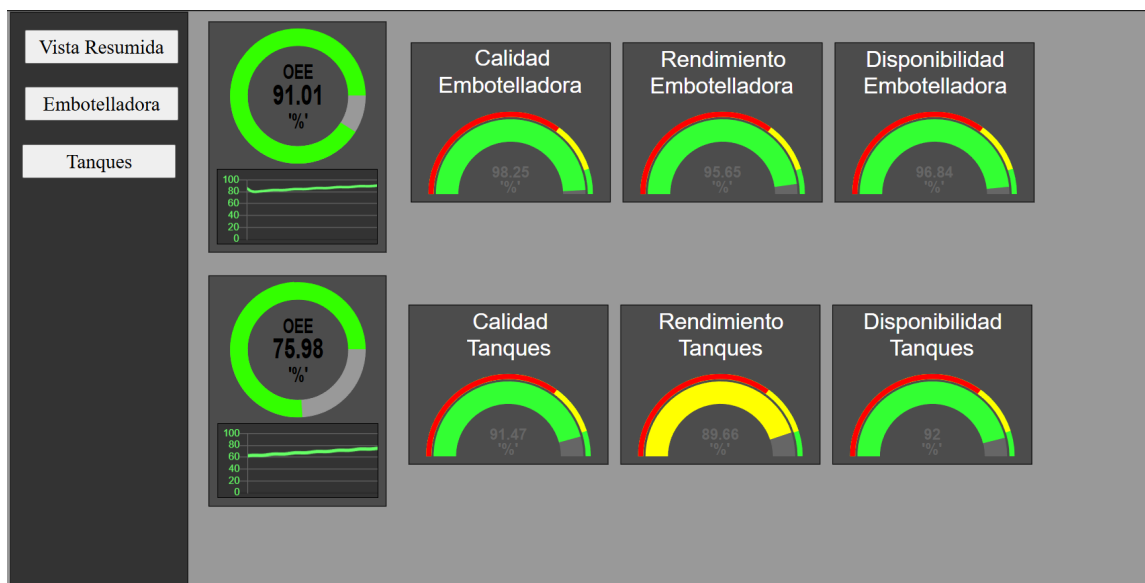
Figura 4.10 Vista resumida del dashboard con indicadores de OEE y KPI operativos.
