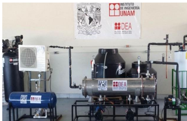
Figura 17. Prototipo de desaladora modular geotérmica (Grupo iiDEA, 2025)
