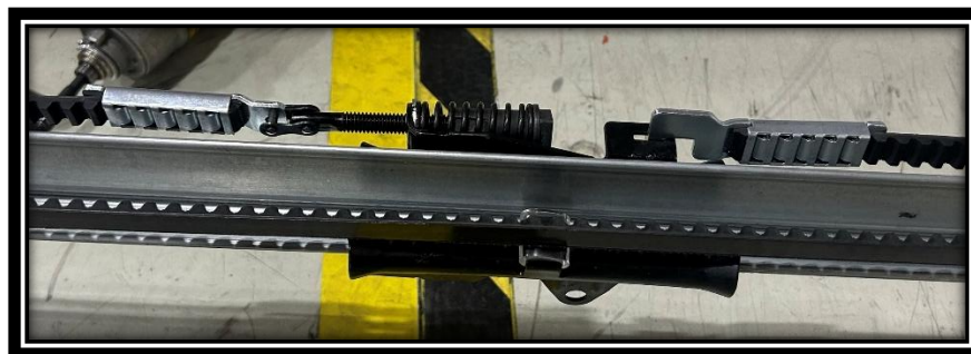
Figura 12. Ensamble de remachados al trolley.
