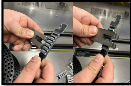
Figura 28. Gauge “Go, No-Go” del remachado
