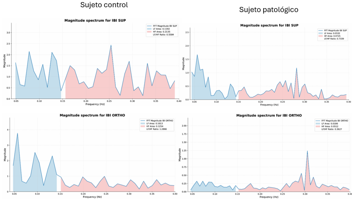
Ilustración 3.17: Ejemplo de implementación para sujeto control de lado izquierdo y para patológico en la parte derecha, para supino en parte superior y para bipedestación en la inferior, puede observarse una disminución de la actividad cardiovagal al pasar de supino a bipedestación en el sujeto control y un bajo nivel de actividad simpática en el caso del sujeto patológico durante el período supino.
