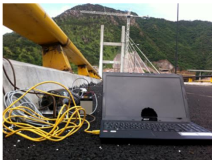
c) Equipo de cómputo (der.) y batería de 12 volts (izq.)
