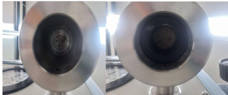
Figura 16: Portamuestras en donde se coloca la manga de hule.
