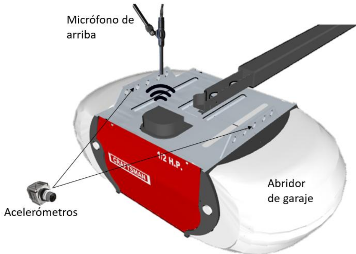
Figura 1. Diagrama del posicionamiento del micrófono de arriba y acelerómetros.
