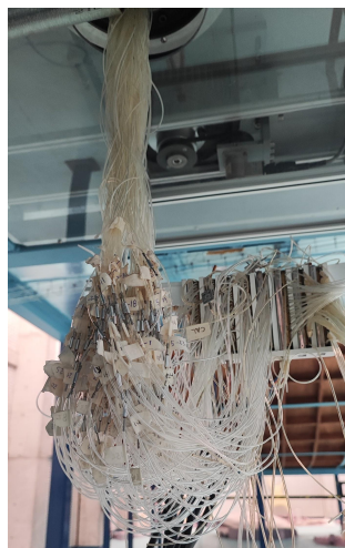
Figura 3.18 Interconexión de las tomas de presión a los zocs
