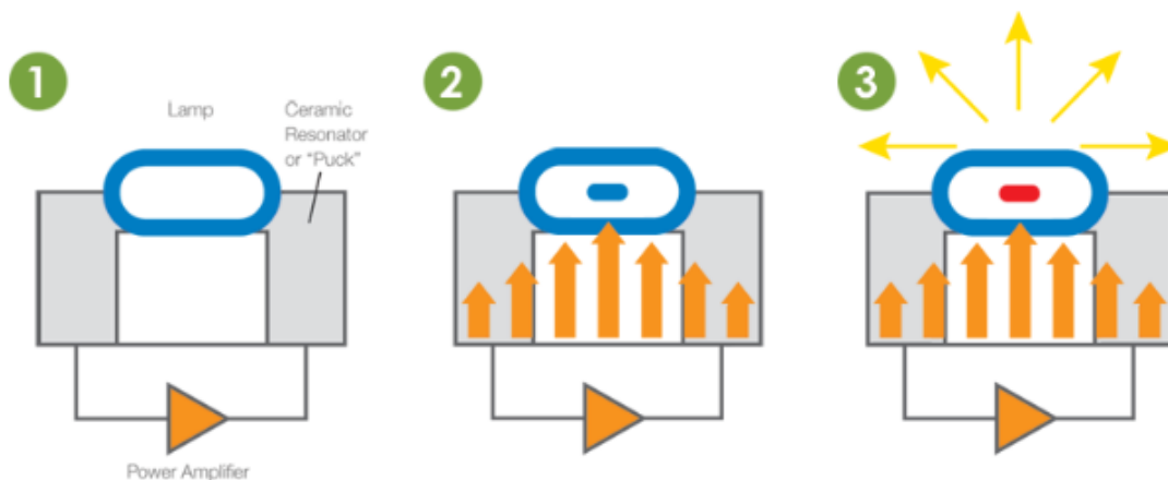
Figura 9. Principio de funcionamiento de la lámpara de plasma. De “¿Qué son y cómo funcionan las lámparas de plasma?”, por Iluminet, 2014 ( https://iluminet.com/iluminacion-plasma/ ).
