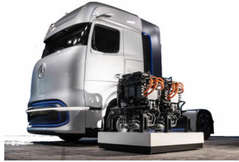
Figura 14: Mercedes Benz GenH2. Vehículo pesado con celda de combustible. [1]
