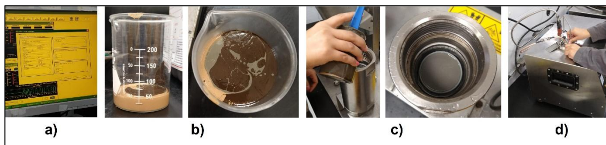
Figura 3.47. Procedimiento para la prueba de resistencia al esfuerzo compresivo en laboratorio.
