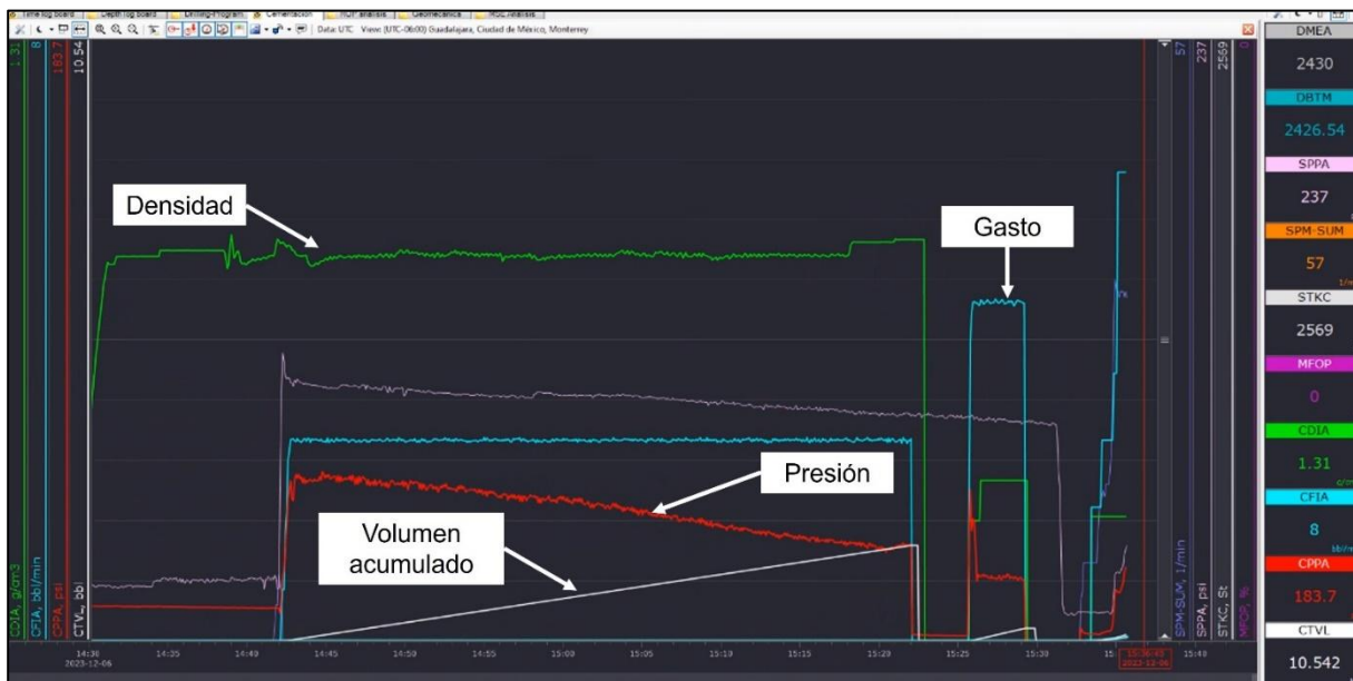
Figura 3.8. Gráfica del comportamiento de los parámetros de bombeo durante el trabajo de cementación de una TR.
