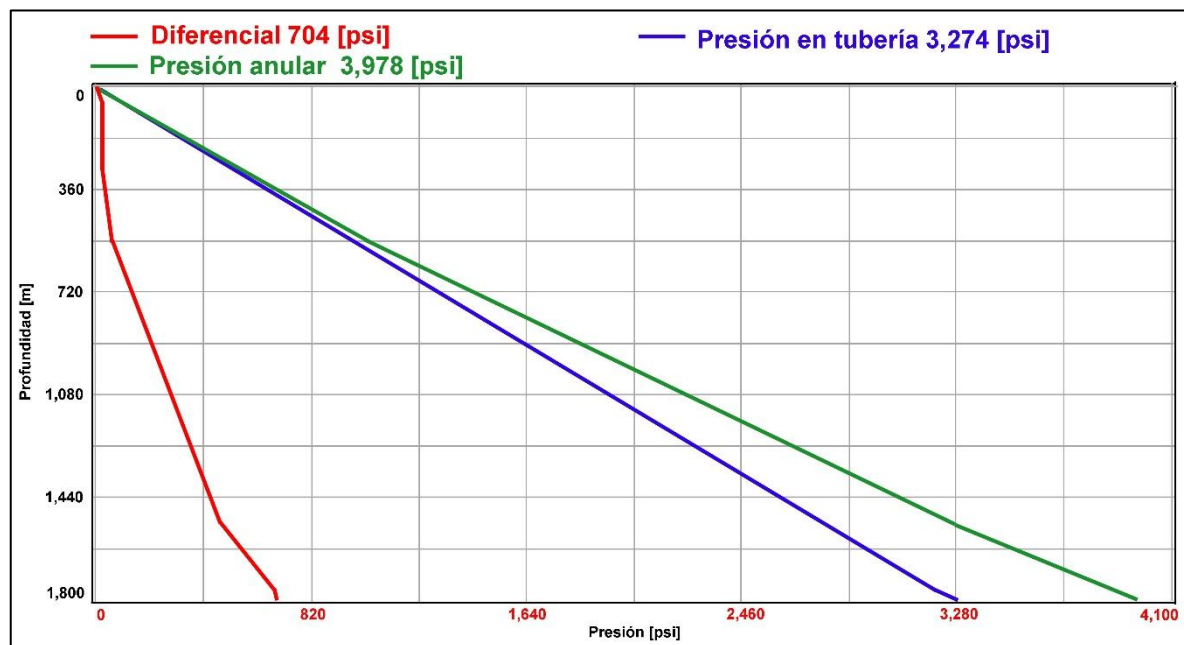
Figura 5.16. Presión diferencial en la cementación de la TR de 16 pg a 1,800 md.
