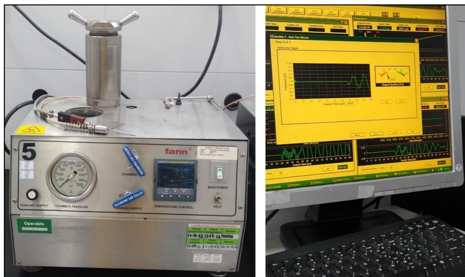
Figura 3.46. Analizador Ultrasónico de Cemento utilizado en pruebas no destructivas de resistencia a la compresión.
