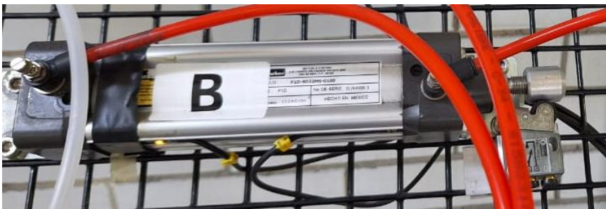
Imagen 119 Pistón B; sensor de efecto Reed "b0" encendido
