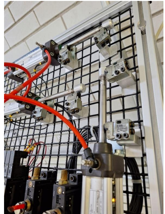
Imagen 126 Movimientos A+, B+ y C+; mesa neumática
