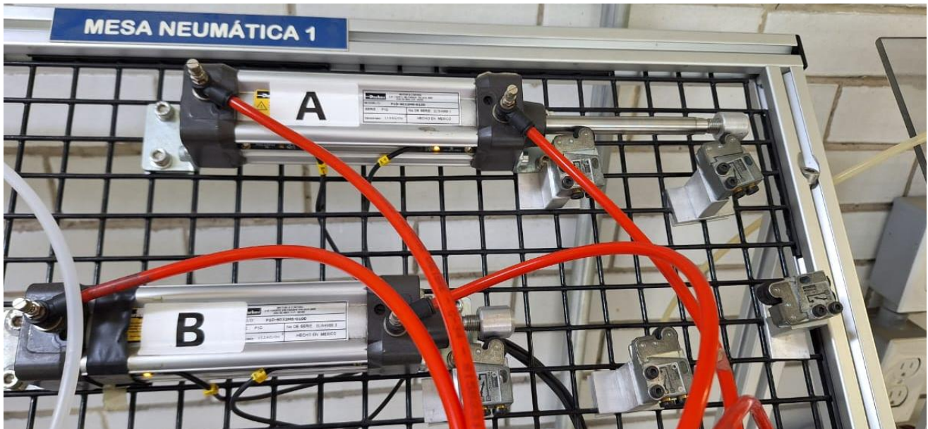
Imagen 92 Activación del vástago A desde el entorno virtual
