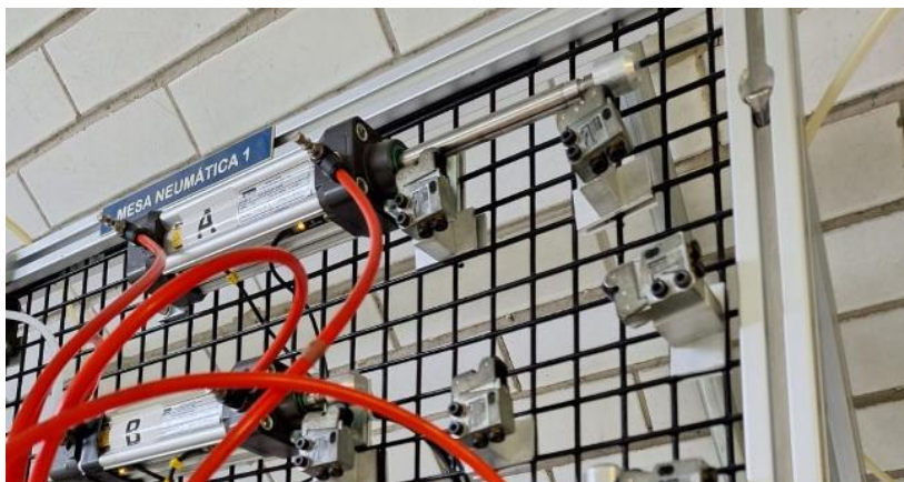
Figura 133 Activación del actuador A (Movimiento A+)
