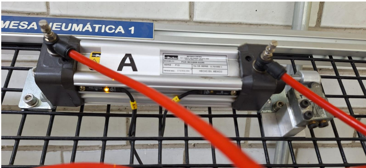
Imagen 94 Retroceso de vástago mediante la activación de botón enclavado virtual
