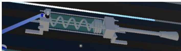
Imagen 7 Visualización de funcionamiento de un pistón de simple efecto en el laboratorio virtual.
