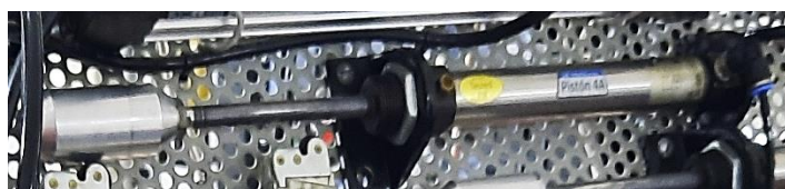
Imagen 8 Visualización de funcionamiento de un pistón de simple efecto físico.
