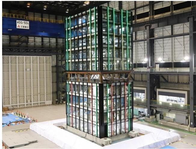
Figura 3.1 Prueba de un modelo a escala de un edificio de oficinas de 10 pisos en una mesa vibradora tridimensional, registrando datos mediante sensores en sus pilares y muros. Fuente: Centro de Ingeniería Sísmica de Hyogo.
