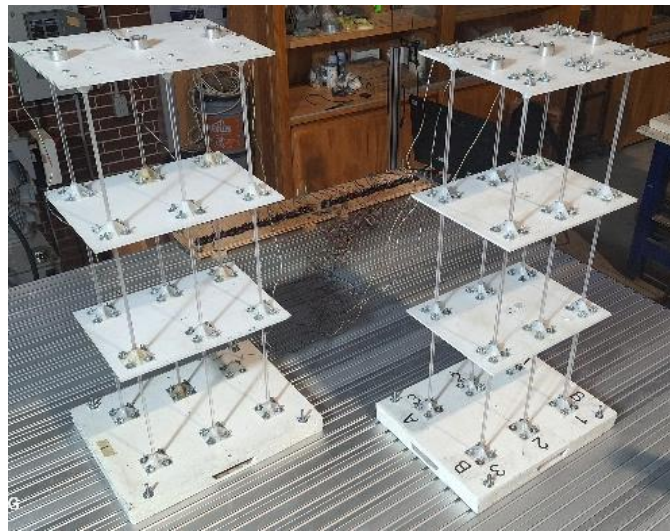
Figura 5.5 Modelos estructurales físicos de edificios de 3 niveles.
