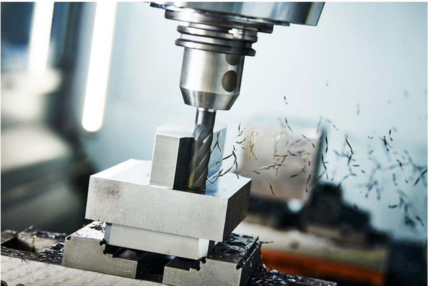
Ilustración 11. Manufactura sustractiva de metales; proceso de fresado de un bloque de metal. Fuente: https://www.china-machining.com/blog/what-is-cnc-milling/
