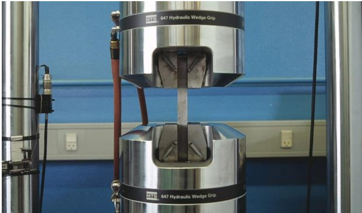
Ilustración 10. Configuración de un ensayo de tensión para una probeta metálica, a partir del cual se obtienen algunas propiedades mecánicas del material. Fuente: https://forcetechnology.com/en/services/materials/tensile-testing
