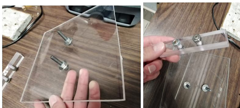
Figura 2.7: Ensamblado de la placa y barras de sujeción con tornillos y tuercas.
