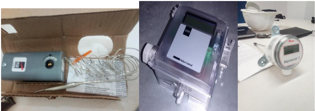
Figura 16 C: Sensores de presión, de temperatura y de humedad
