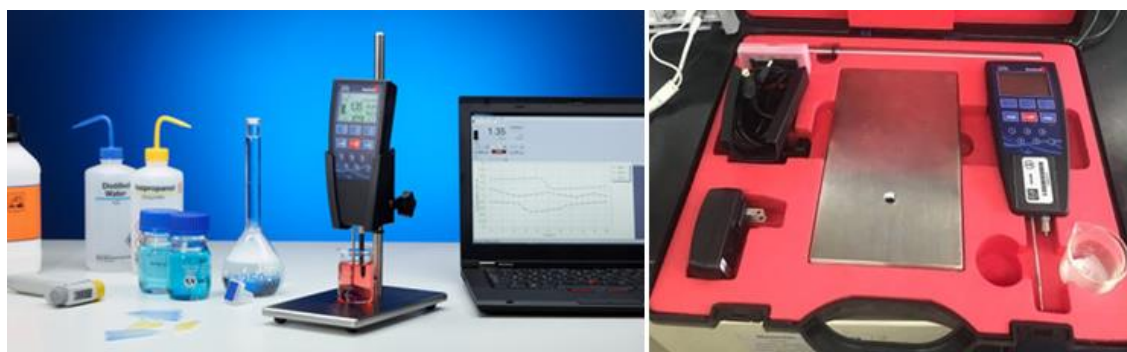
Figura 7. Tensiómetro SITA DynoTester+. Imagen derecha tomada en el Laboratorio de Interacción Roca-Fluido y Fluido-Fluido, UNAM. Imagen izquierda recuperada de: https://www.sita-lab.com/products/sita-tensiometer/sita-dynotester/
