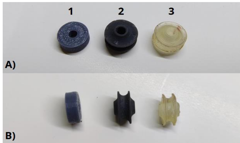
Fig 14. A) Vista frontal de las pruebas de la rueda D y B) Vista lateral de las pruebas de la rueda D (1 prueba PLA, 2 Prueba resina flexible y 3 prueba resina elástica).
