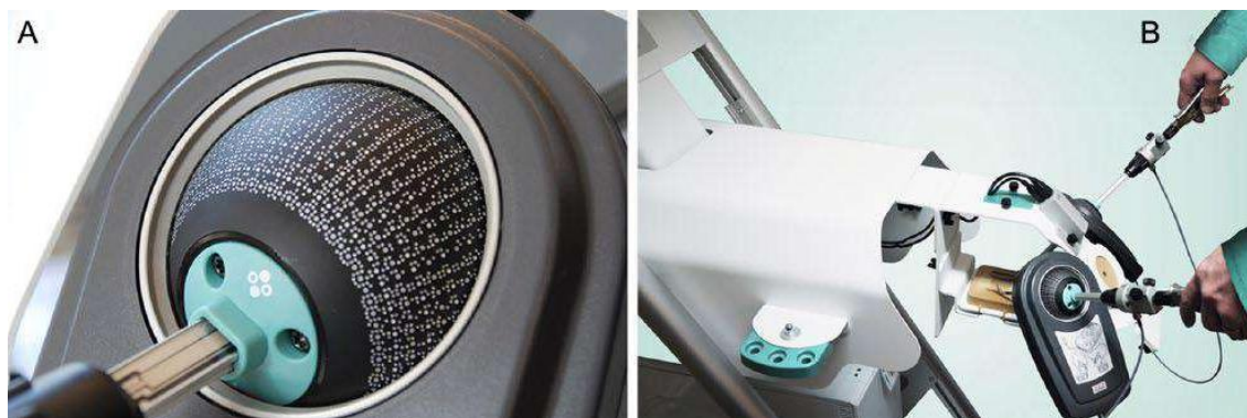
Fig. 3 A) Rótula del sistema Simball Box, B) Colocación del instrumental quirúrgico en el sistema Simball Box. Hagelsteen et al., (2016)
